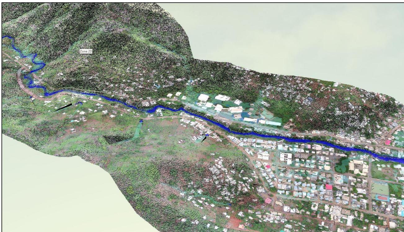
Figure 112 : Illustration 3D des écoulements d'une crue centennale de la rivière Mro Oua Doujani et ses affluents sur la zone d'étude (Etat projet)
