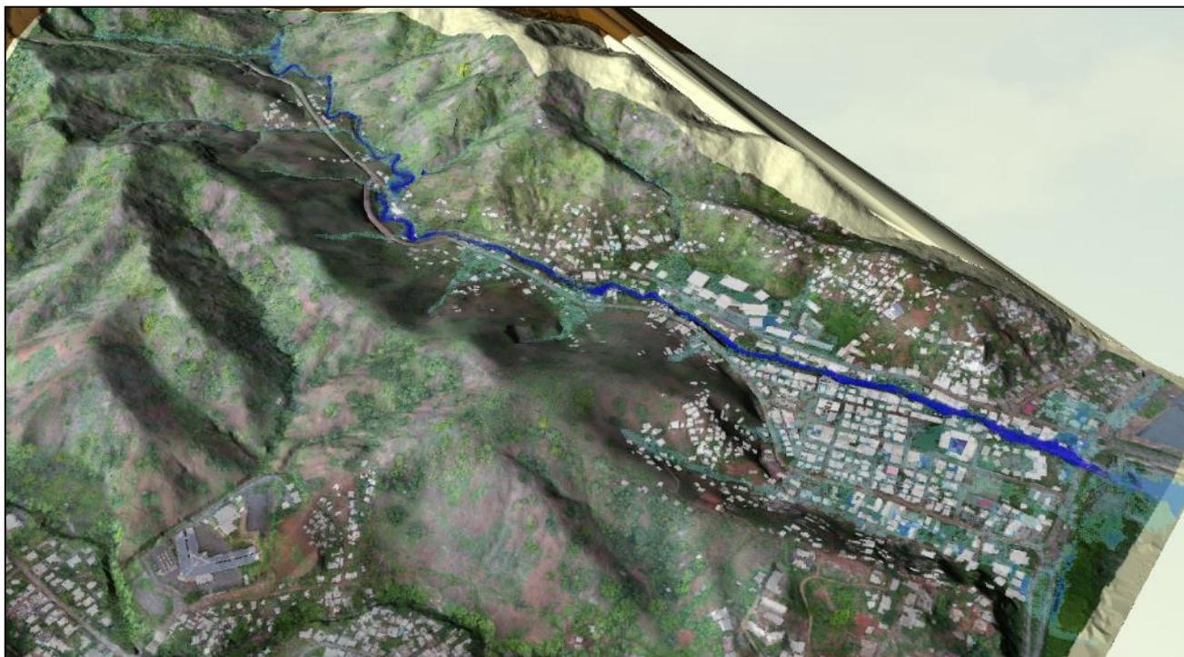
Figure 91 : Illustration 3D des écoulements d'une crue centennale de la rivière Mro Oua Doujani et ses affluents sur la zone d'étude (Etat initial)
