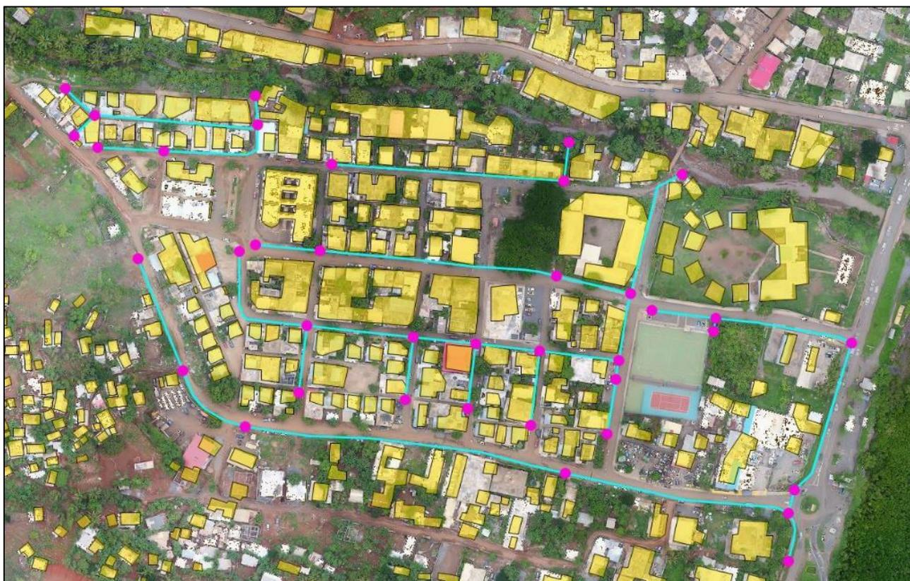
Figure 84 : Architecture du réseau de gestion des eaux pluviales existants
