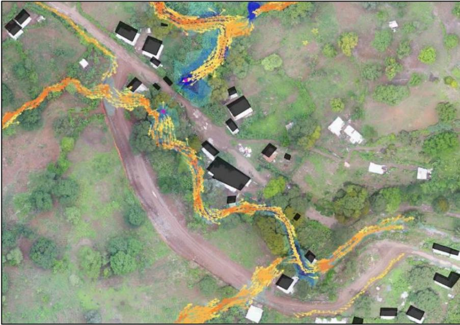
**Q = 7m<sup>3</sup>/s :** Arrivée des écoulements provenant de la rivière Doujani au droit de l'ouvrage de franchissement. Plusieurs talwegs rive droite et rive gauche alimentent la rivière par des écoulements diffus en ruisselant sur la chaussée avant de rejoindre le lit mineur plus marqué de la rivière.
