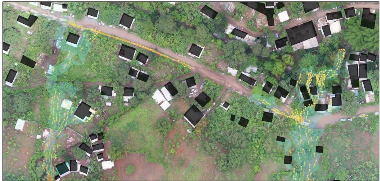
**Q = 0.70 et 1.00m<sup>3</sup>/s :** Arrivée des écoulements provenant de deux talwegs rive droite au droit de la piste. Les écoulements sont diffus et la lame d'eau s'étale progressivement au travers des habitations.
